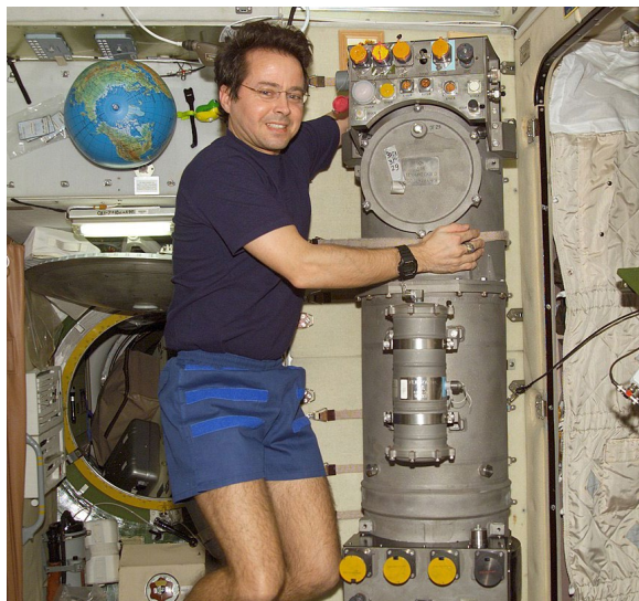
Astronauta Daniel Bursch trabaja en el generador de oxígeno Elektron en la EEI.
